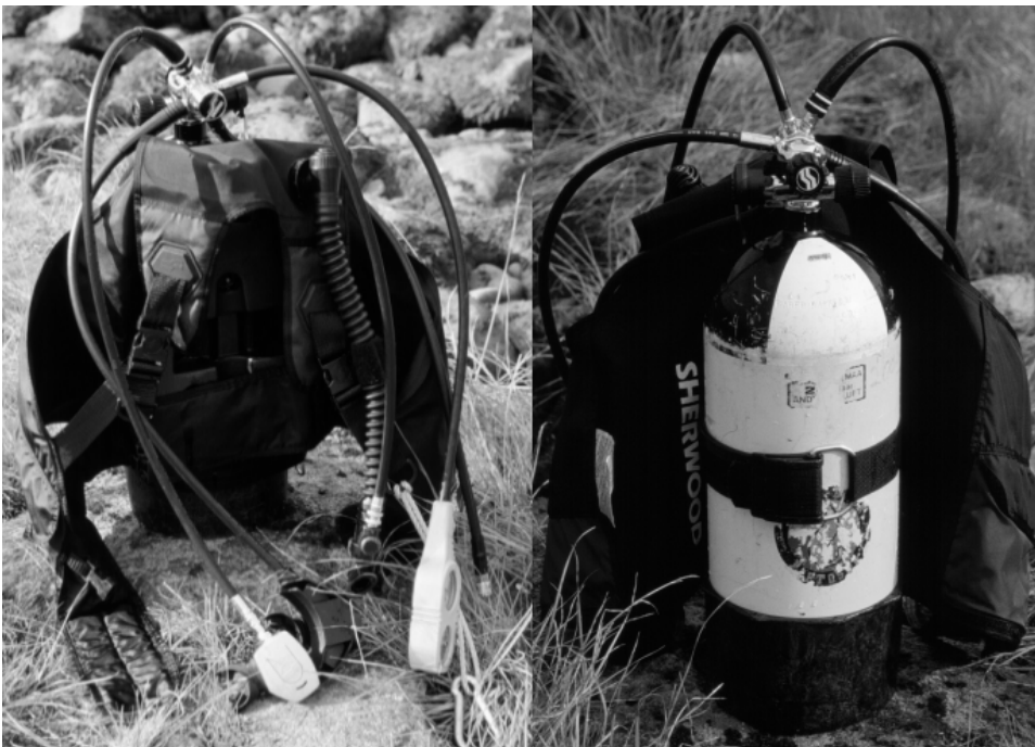
Kuva 3. Paineilmalaitteet: Tasapainotusliivi, matalapainesyöttö, regulaattorin 1. ja 2. vaihe, vaihtoehtoinen ilmanlähde, instrumenttikonsoli ja paineilmasäiliö.
